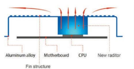
При 100% нагрузке, температура на 20-30°C ниже, чем при традиционной системе охлаждения
