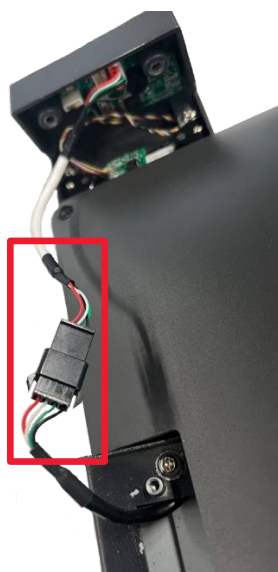
Рисунок 16. Соединение MSR с POS-терминалом
