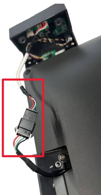
Рисунок 9. Подключение кабеля MSR к кабелю терминала
