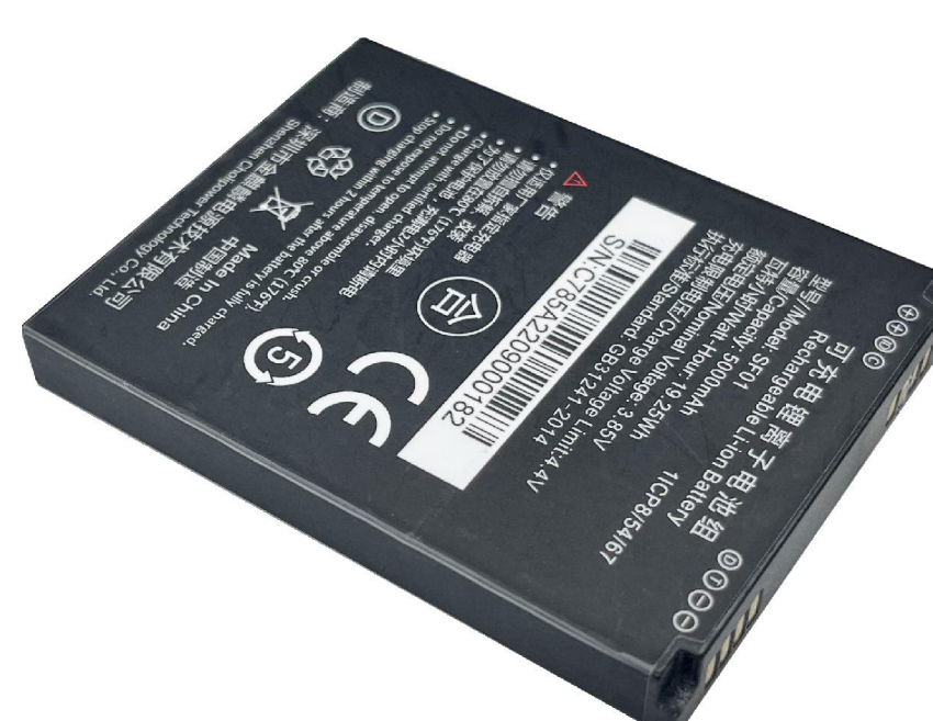
Аккумулятор P/N: CHA-BTRY-T3 Pro-5000MA 5000 мАч, 3.85 В.
